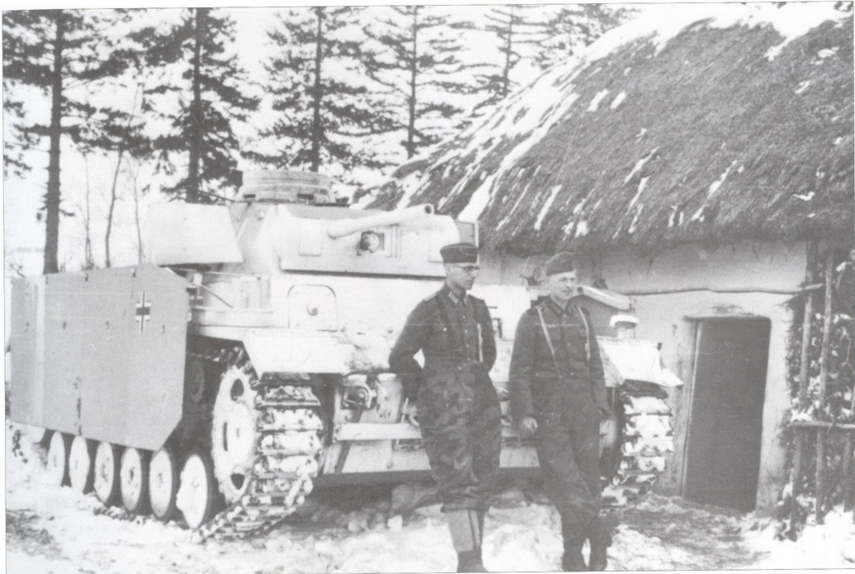
A Pz.Kpfw.III Ausf.H (Beobachtungswagen) with side Schürzen on the Eastern Front, winter 1943/1944.
