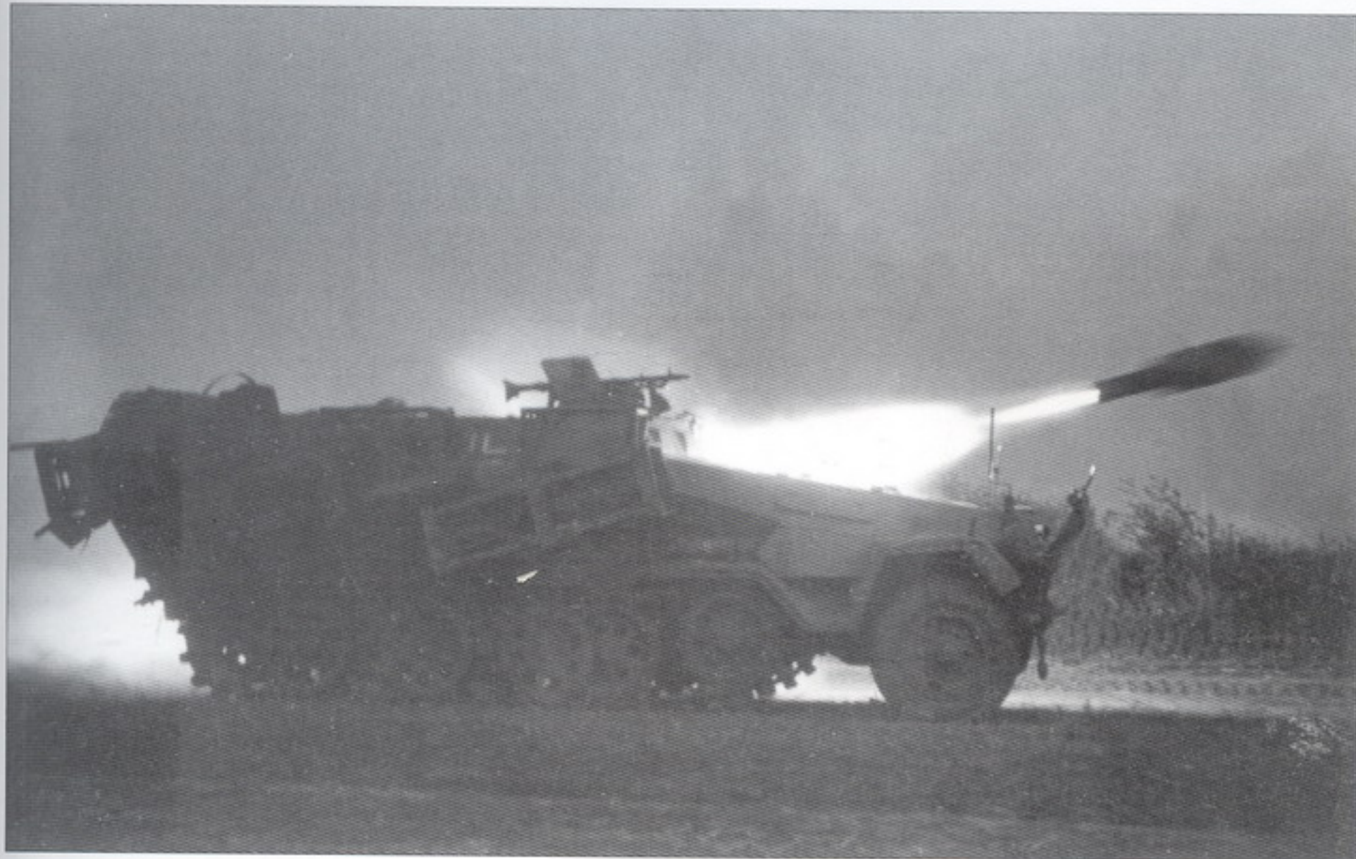
An Sd.Kfz.251/1 Ausf.B as a mittlerer Schützenpanzerwagen mit Wurffrahmen during firing of its rockets at enemy positions.
