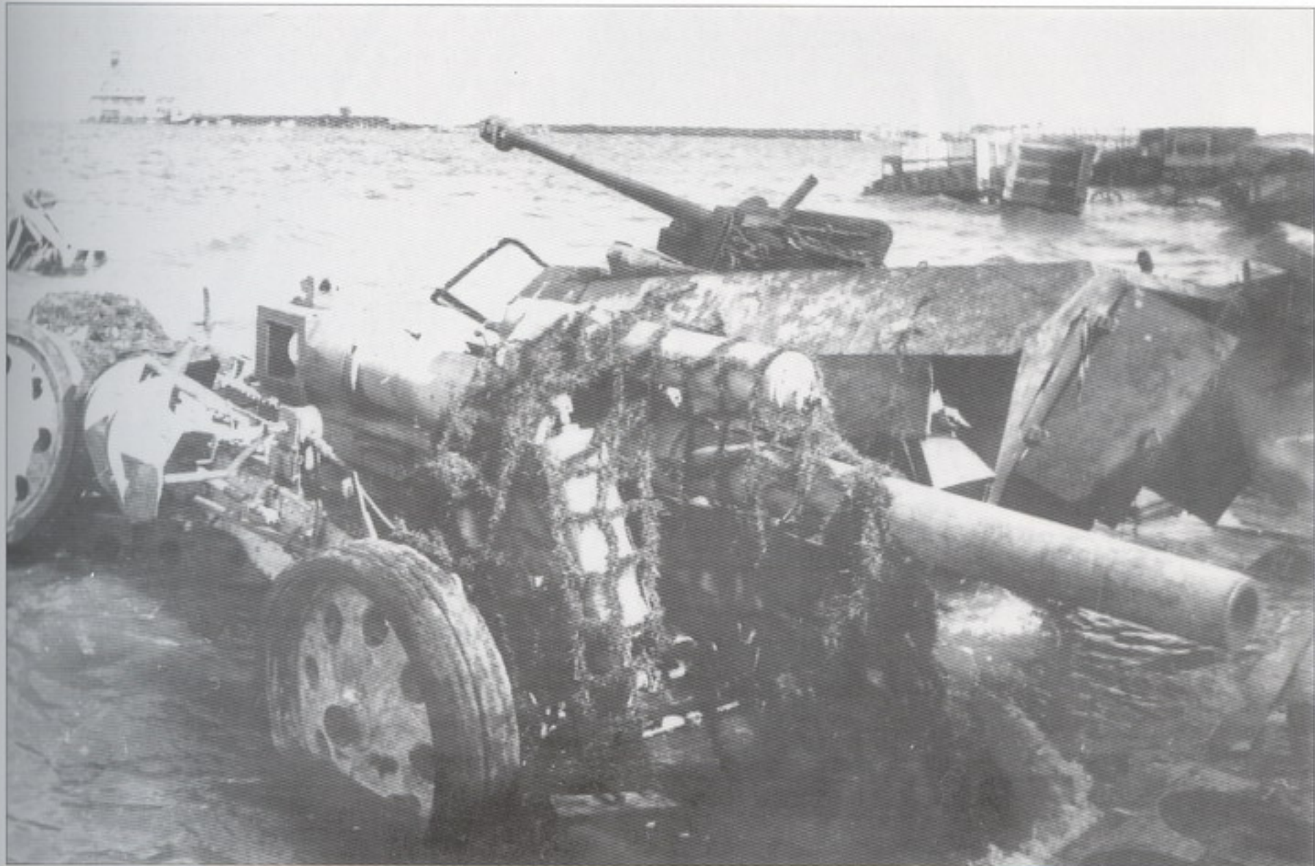
An Sd.Kfz.251/22 Ausf.D (mittlerer Schützenpanzerwagen mit 7.5 cm Pak 40 L/46) of 7.Panzer Division, on the Baltic coast, March 1945.
